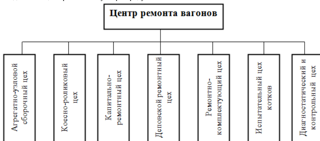
Рис. 4. Структура центра ремонта вагонов
