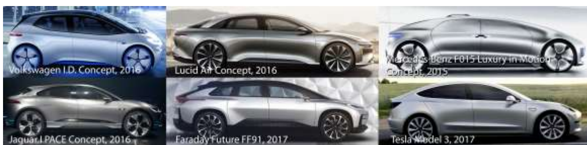
Рисунок 6. Единый подход к формообразованию кузова, упрощение форм: растянутый по длине объём кузова, образованный S-образной профильной линией
