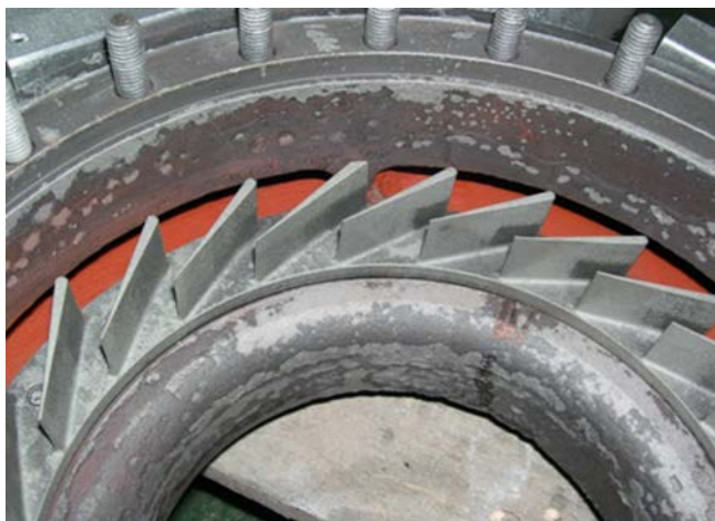
Корпус с корозионни повреди
