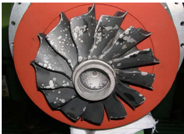
Турбинно колело с корозионни язви
