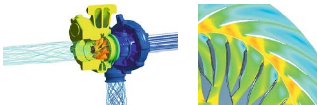
Фиг.1 Триизмерно моделиране на ТКА (Voith Turbo) и CFD пресмятане на параметрите на въздуха в центробежен компресор (MAN) [7]
