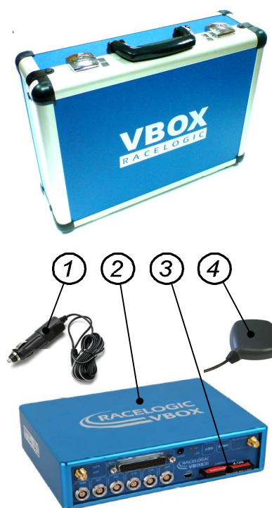
Фиг. 1. VBOX 3i: 1- Захранващ кабел; 2-GPS модул; 3-SD карта; 4- GPS антена.
